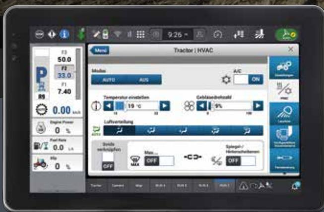
Die neue HVAC-Klimaanlage mit Druckbeaufschlagung verfügt über mehr Lüftungsöffnungen und Lamellen, um den Luftstrom um den Fahrer zu verstärken. Sie kann auch direkt über den Encoder oder die konfigurierbaren Tasten gesteuert werden.
