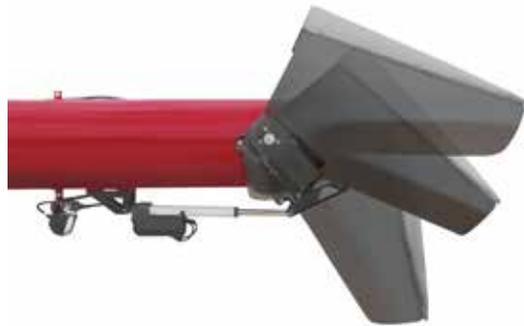
La boca pivotante de descarga opcional accionada con la palanca multifunción dirige el flujo de grano hasta el interior del carro de grano llenándolo hasta la parte superior sin derramarlo.
