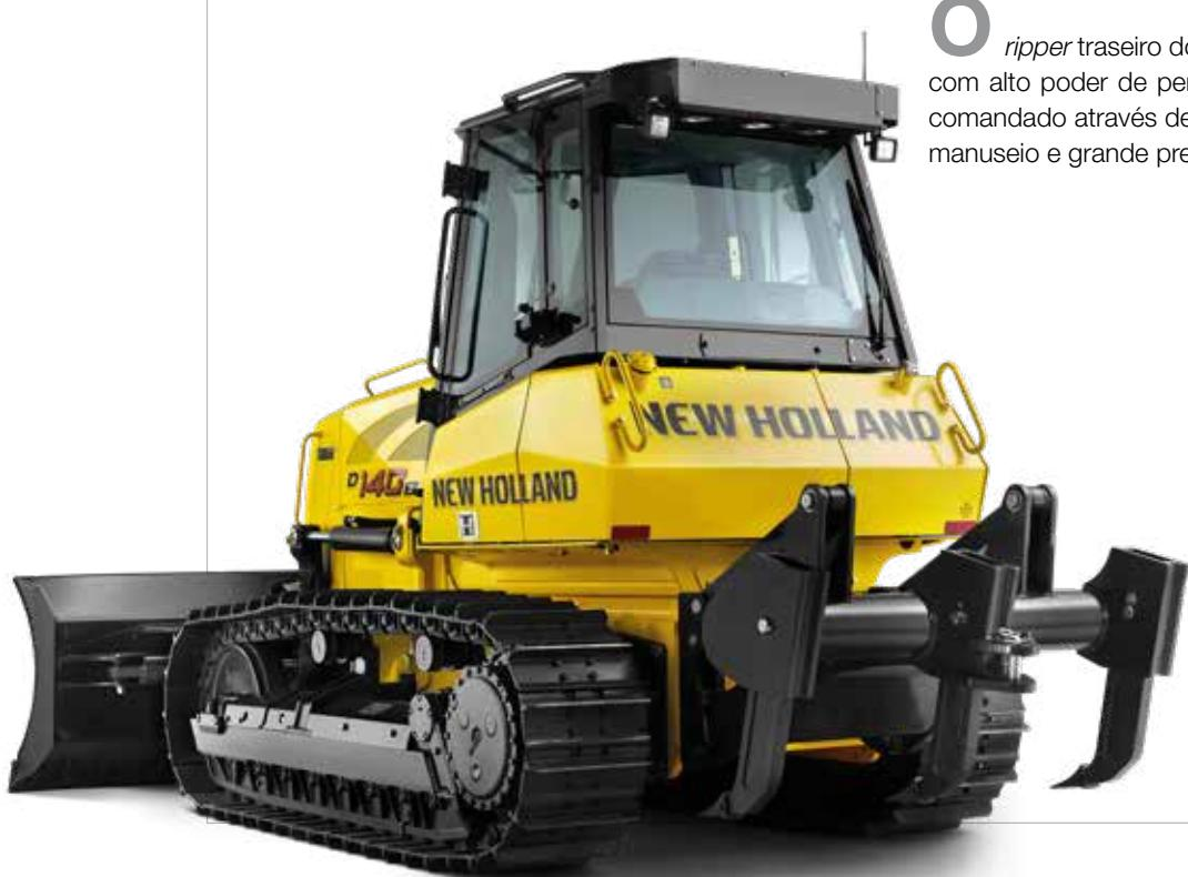
O ripper traseiro do tipo paralelogramo possui três dentes com alto poder de penetração e grande profundidade. Ele é comandado através de uma alavanca eletro-hidráulica de fácil manuseio e grande precisão.
