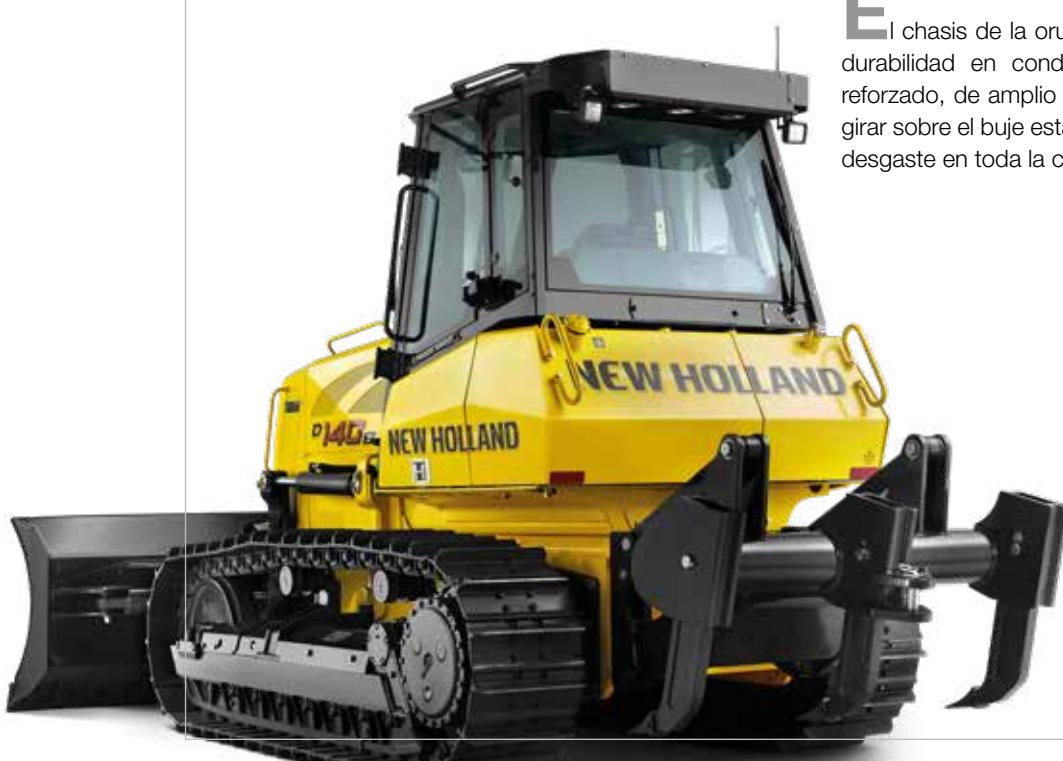
**E**l chasis de la oruga, de larga vida útil, ofrece una alta durabilidad en condiciones abrasivas. Emplea un buje reforzado, de amplio diámetro, que se mantiene libre para girar sobre el buje estándar, lo que facilita la distribución del desgaste en toda la circunferencia del buje externo.
