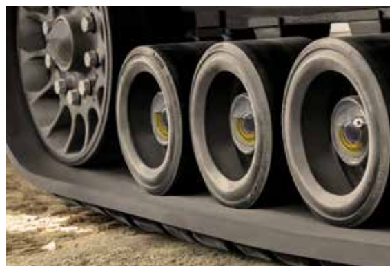
Oljeinspektionsfönster i hjulnaven underlättar dagliga kontroller.
