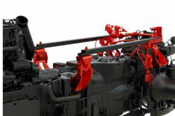
Den semiaktiva hydrauliska hyttfjädringen absorberar tillförlitligt skakningar och vibrationer.
