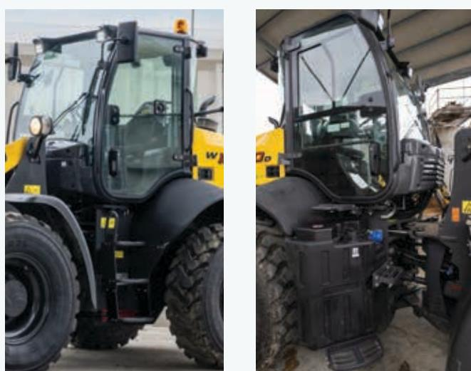
La spaziosa cabina certificata ROPS/FOPS Livello 2 è dotata di porte completamente vetrate su entrambi i lati per un facile accesso e una visibilità panoramica senza ostacoli durante le manovre, garantendo la massima sicurezza ed efficienza operativa. Le maniglie di sostegno sono posizionate esattamente dove servono per salire e scendere in sicurezza.
