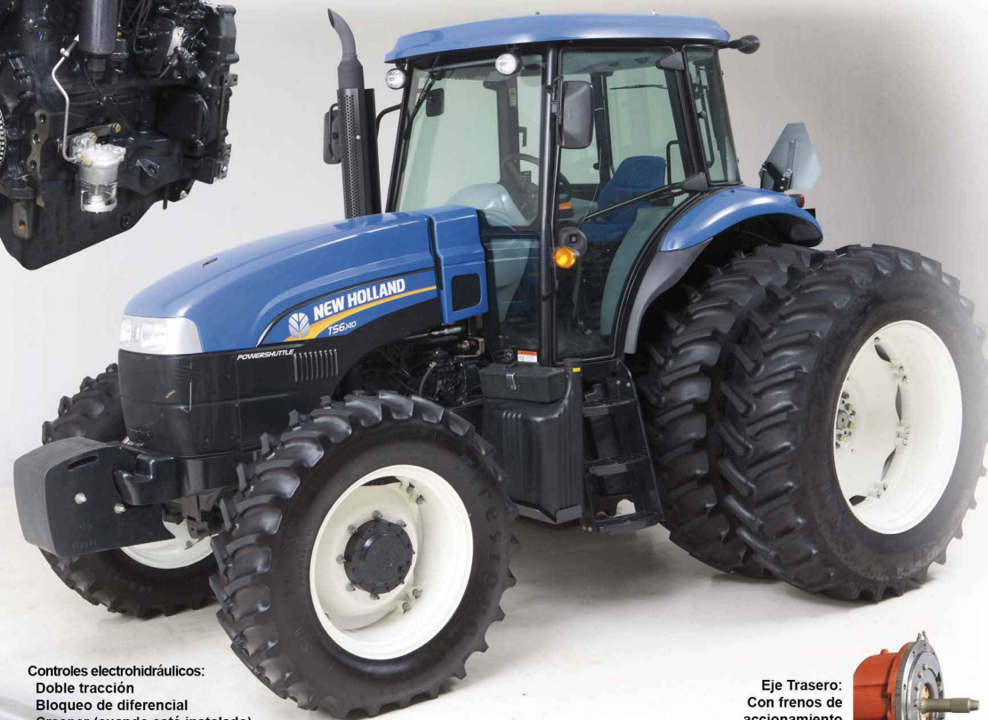
Puesto de Operación: Plataforma y Cabina ROPS ergonómica y con excelente visibilidad.
