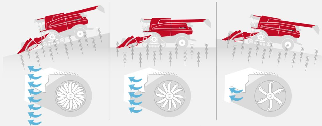
O ventilador da limpeza automática ajusta-se nos declives
