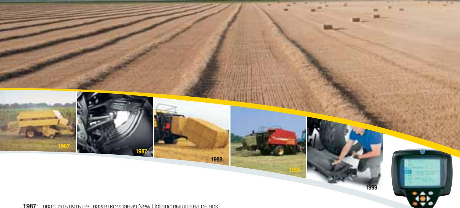
**1987:** двадцать пять лет назад компания New Holland вышла на рынок больших тюковых пресс-подборщиков, представив свою модель D1000. В конструкции этой машины был реализован целый ряд новаторских решений, включая двойные узловязатели, электронную систему пропорциональной регулировки плотности прессования, механизм полной разгрузки, а также совершенно новый размер тюка - 80 см x 90 см. Спустя четверть столетия эти нововведения от компании New Holland стали отраслевыми стандартами.
