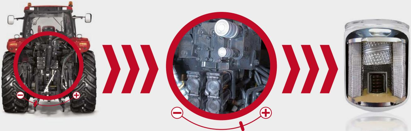
Die erste Funktion des Filters besteht darin, **alle Partikel zurückzuhalten, die eine abrasive Wirkung haben** und so die Bauteile des Hydrauliksystems wie Pumpe, Verteiler, Kolben oder Hydraulikmotor angreifen würden.
