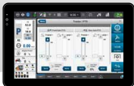
INTUITIV LAYOUT FÖR AUTOMATISK UR-/INKOPPLINGSINSTÄLLNING FÖR HÖJDBEROENDE FRÄMRE OCH BAKRE KRAFTUTTAG
