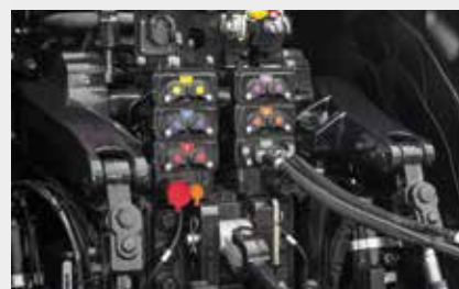
DIE NEUEN ELEKTROHYDRAULISCHEN STEUERGERÄTE BIETEN EINEN HÖHEREN DURCHFLUSS UND EIN SCHNELLERES ANSPRECHVERHALTEN BEI VERBESSERTER HALTBARKEIT.
