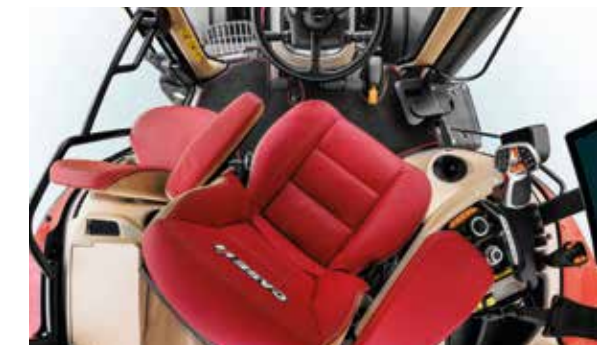
DER FAHRERSITZ LÄSST SICH UM BIS ZU 40° DREHEN - FÜR FREIE SICHT AUF DIE ANBAUGERÄTE.
