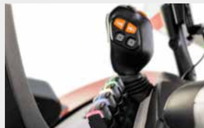
DER JOYSTICK ERMÖGLICHT EINE PRÄZISE STEUERUNG DER FUNKTIONEN DES FRONT- UND HECKKRAFTHEBERS MIT DEN FINGERSPITZEN - FÜR EINEN REIBUNGSLOSEN BETRIEB.
