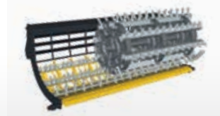
CILINDRO UNIVERSAL, BARRAS DE TRILLA PARA ARROZ Y CÓNCAVO PARA ARROZ
